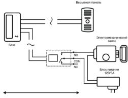
Максимальная длина кабеля 0-100м для 0,65мм^2 100-150м для 0,8мм^2 Схема подключения электромех. замка более 60м
